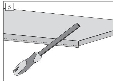
Vent så 6 timer for å være sikker på at limet er tilstrekkelig herdet. Overskytende del av listen på toppen pusses så den blir jevn. Stryk filen fra deg for å ikke dra i listen. Overflødig kantlist i bunnen kan kuttes bort med tapetkniv.
