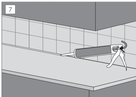
Utskifting av benkeplate ved oppussing: Hvis det er fliser på veggen mellom benk og overskap, kan det være en fordel om benkeplaten monteres utenpå disse. Dette vil gjøre det lettere å bytte plate senere uten å skade flisene. OBS! Før benkeplaten skyves på plass må det være igjen en spalte på ca 3-5 mm. Påfør en stripe fugemasse. Skyv platen på plass og fjern overskytende fugemasse med Fibo Clean og fugekloss (Fibo Fug).
