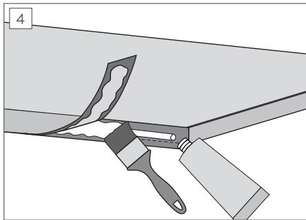
Puss sagsnittet med en trekloss og sandpapir. Bruk pensel til å påføre jevnt 3 lag våt med lim på sponflatene, og ett lag på baksiden av kantlisten. Når limet er støvtørt settes de to flatene sammen. Se også anbefalinger fra leverandør av kontaktilm. Vær nøyaktig med posisjonering slik at listen treffer toppen av benkeplaten. Bruk jevnt trykk. Sørg for å ikke stenge inne luftbobler.
